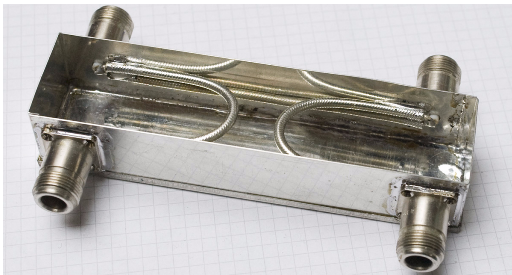
Bild 12 „Kleiner“ Koppler mit N-Buchsen und 35-Ohm-Kabel.
