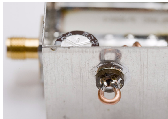
Bild 1 Lötbare Durchführungskondensator, geeignet für hohe Ströme, und seine Anwendung.
