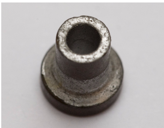
Bild 1 Lötbare Durchführungskondensator, geeignet für hohe Ströme, und seine Anwendung.
