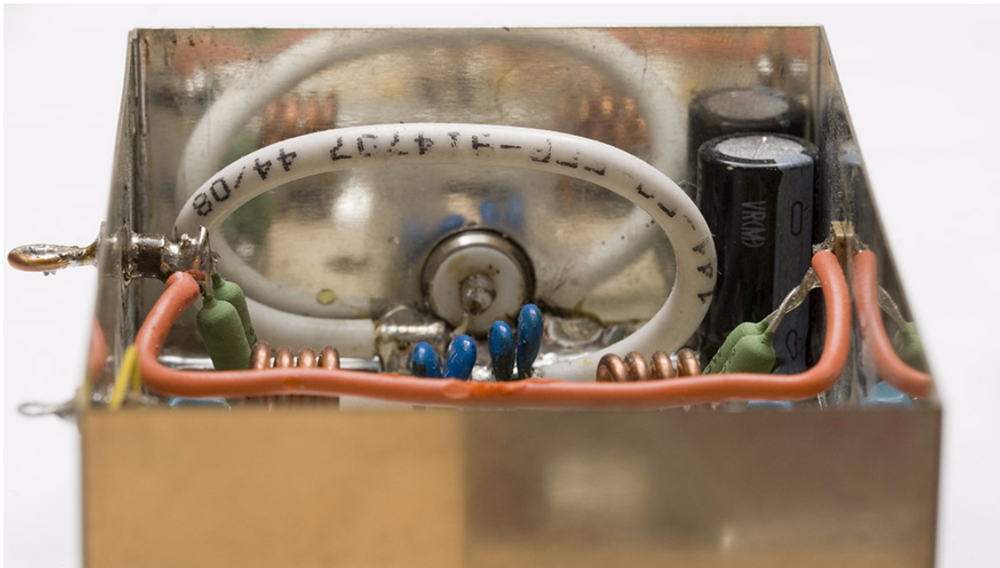
Bild 4 Gegentakt-PA 432 MHz mit 2 x MRF6V4300; Anordnung des Ausgangsbaluns.
