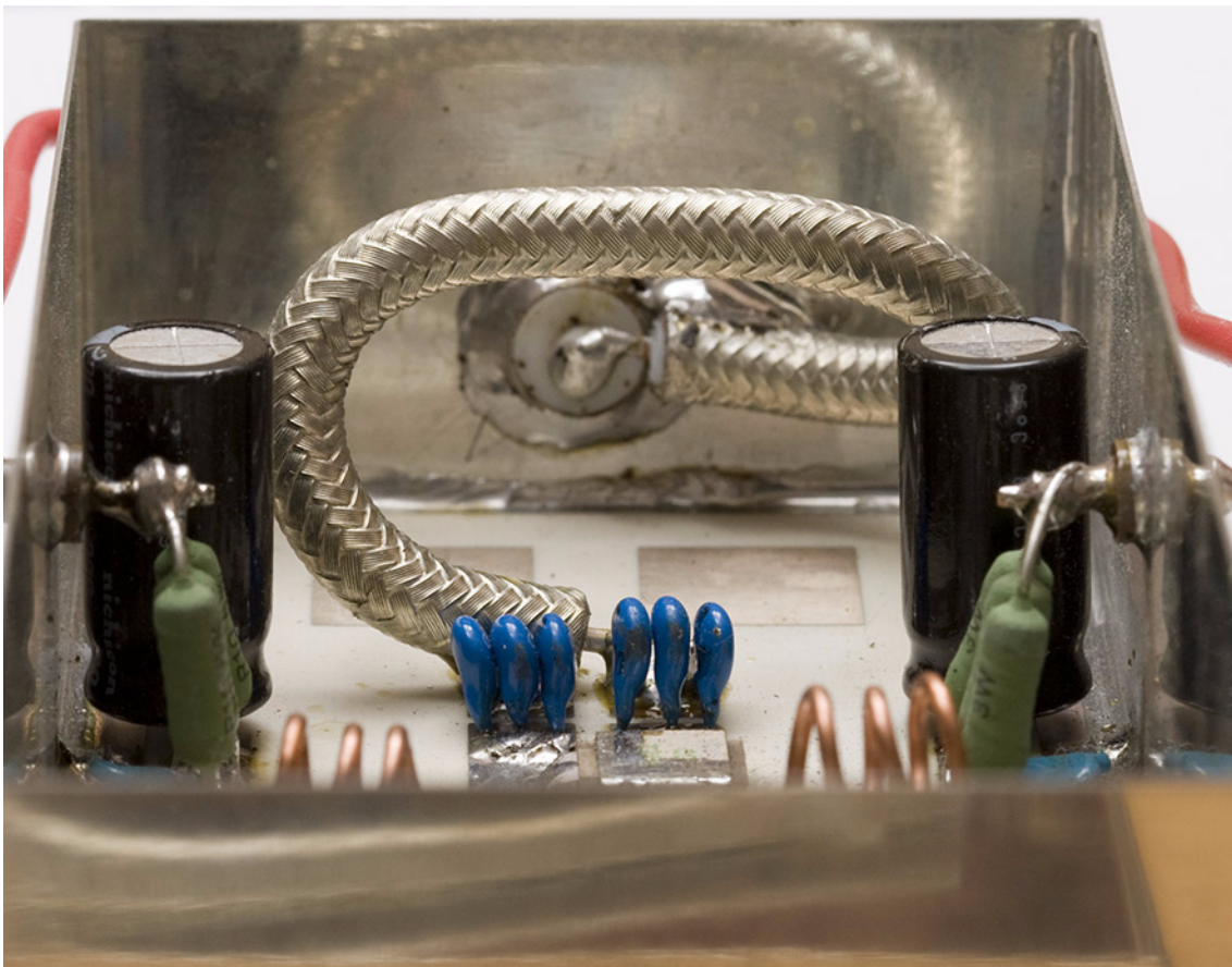
Bild 6 Gegentakt-PA 432 MHz mit BLF578; Anordnung des Ausgangsbaluns.
